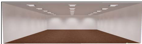
طراحی روشنایی محیط الگو با چراغ MultiTile دارای لوورآندایز MIRO®4 (کاهش تعداد چراغ ها از ۲۰ عدد به ۱۸ عدد)
